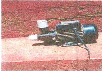
Foto7: Sustitución Bomba de agua
